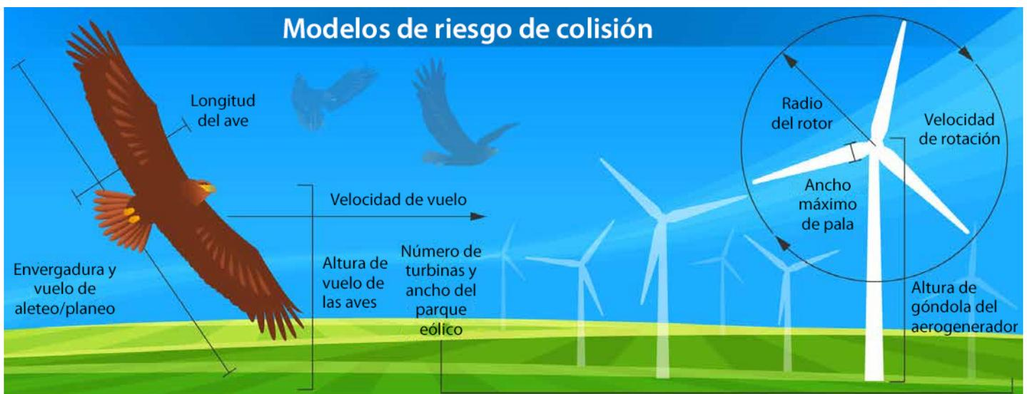
Figura 1. Parámetros que se utilizan a menudo en los modelos de riesgo de colisión. Gráfico del Laboratorio Nacional de Energías Renovables; modificado de Cook y Masden 2019
