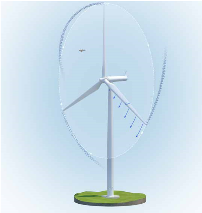
Figura 1. Las regiones de baja presión en el lado de sotavento de la pala y las regiones de alta presión en el lado de barlovento (superficie de la pala) son causadas por aceleraciones de flujo locales. Los vórtices también se forman a favor del viento desde la punta de la pala. Estos pueden causar barotraumatismo en murciélagos. Gráfico de Lawson et al. 2010. Una investigación sobre la posibilidad de que los aerogeneradores causen barotraumatismo en murciélagos. PLoS ONE 15(12): e0242485.
