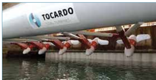
Tocado-Huisman 1,2 MW tidal energy
