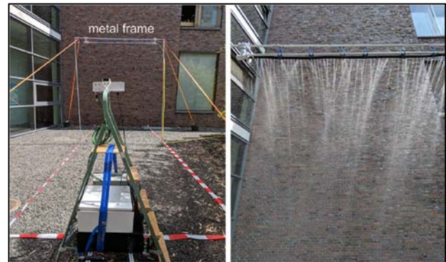
Abbildung 21: (links) Veranschaulichung der radargestützten Regenerkennung in der relevanten Flugzone von Fledermäusen und Vögeln; (rechts) Foto des Versuchsaufbaus. Das Wasser wird vom Metallrahmen in verschiedenen Winkeln auf das Radargerät zu und von ihm weg gesprüht [16].
