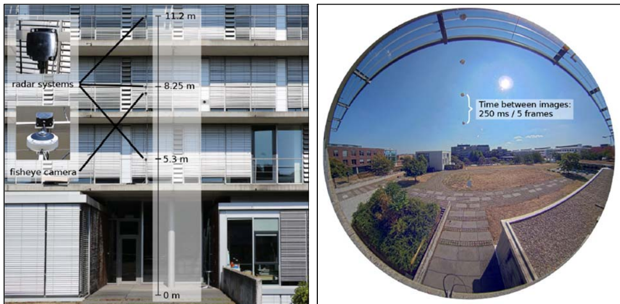
Abbildung 19: (links) Foto des Versuchsaufbaus. Ein Radarsystem wurde auf jedem der drei äquidistanten Balkone montiert. Zusätzlich wurde eine Fischaugenkamera auf dem mittleren Balkon installiert. Von den Balkonen, wurden Fußbälle durch die Erfassungsbereiche der Radarsysteme geworfen; (rechts) Kameraansicht: Mehrere Einzelbilder des Videos eines Wurfes wurden zusammengesetzt. Zwischen den Aufnahmen des Fußballs liegen fünf Bilder bzw. 250 ms [15].
