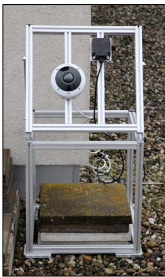
Abbildung 7: (links) Foto von der Dachinstallation mit Kamera und Radarsystem; (rechts) Objekterkennung und Nachverfolgung der Flugbahn zweier Vögel (Kompression eines Videos in ein Bild).
