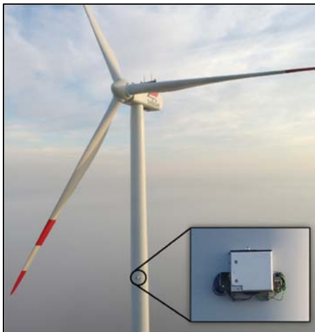
Abbildung 23: (links) Sensorinstallation an der WEA; (rechts) Normalisiertes Histogramm von Regen- und Nicht-Regen-Ereignissen. Wir haben hier nur video-validierte Daten berücksichtigt. Insgesamt wurden 2.781 Ereignisse (252 Regenereignisse und 2.569 regenfreie Ereignisse) ausgewertet. Eine Unterscheidung zwischen diesen Bedingungen ist darüber möglich [16].
