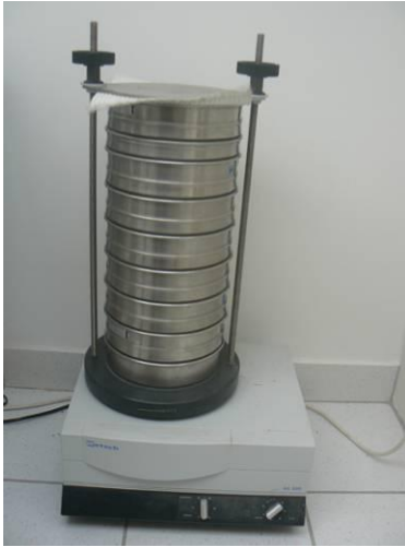
Figure 12 : Colonne de tamis (Cliché TBM).
