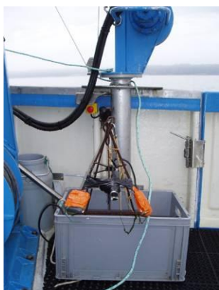
Figure 2 : Caméra sous-marine. (Cliché TBM)
