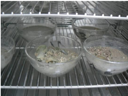
Figure 13 : Echantillons granulométriques à l'étuve (Cliché TBM).
