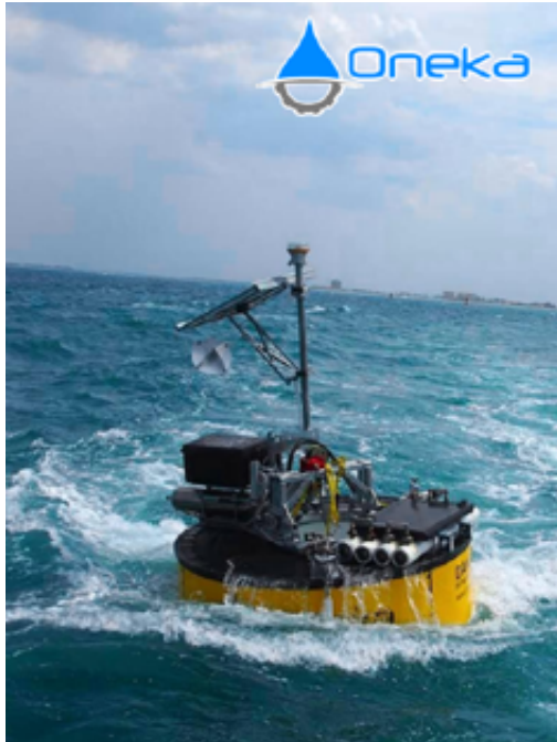
Desalinización: Avanzar hacia un dispositivo de 50 m 3 /día para la industria minera en Chile
