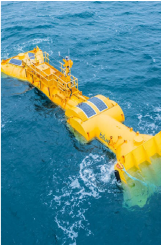
A la izquierda equipo Blue X, convertidor undimotriz de la empresa Mocean de Escocia; a la derecha equipo HiWave-5 de la empresa sueca Corpower.
