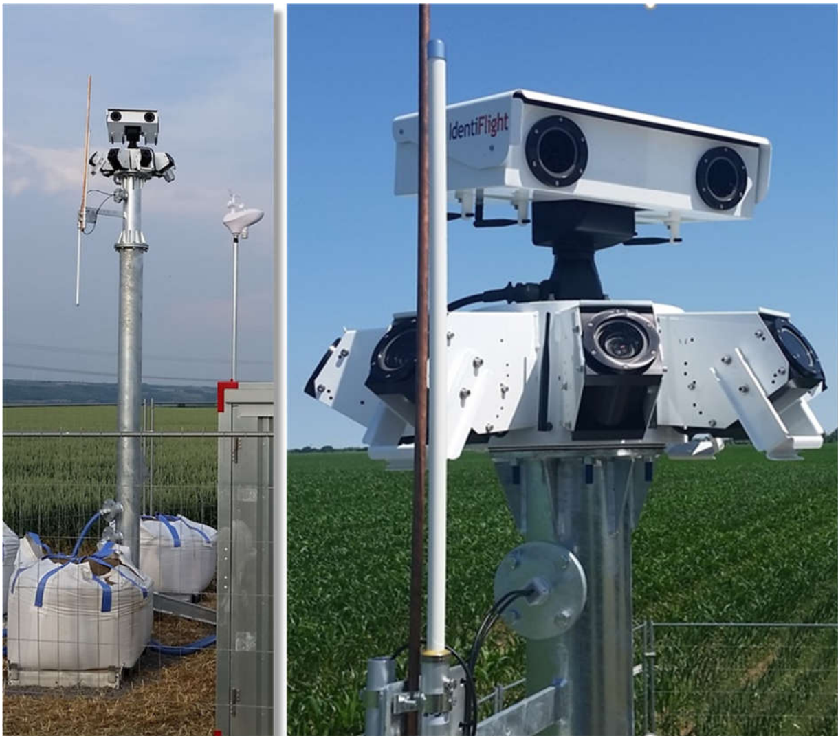
Abbildung 2: Das System IdentiFlight, bestehend aus 8 Weitwinkelkameras und einer beweglichen Stereokamera.
