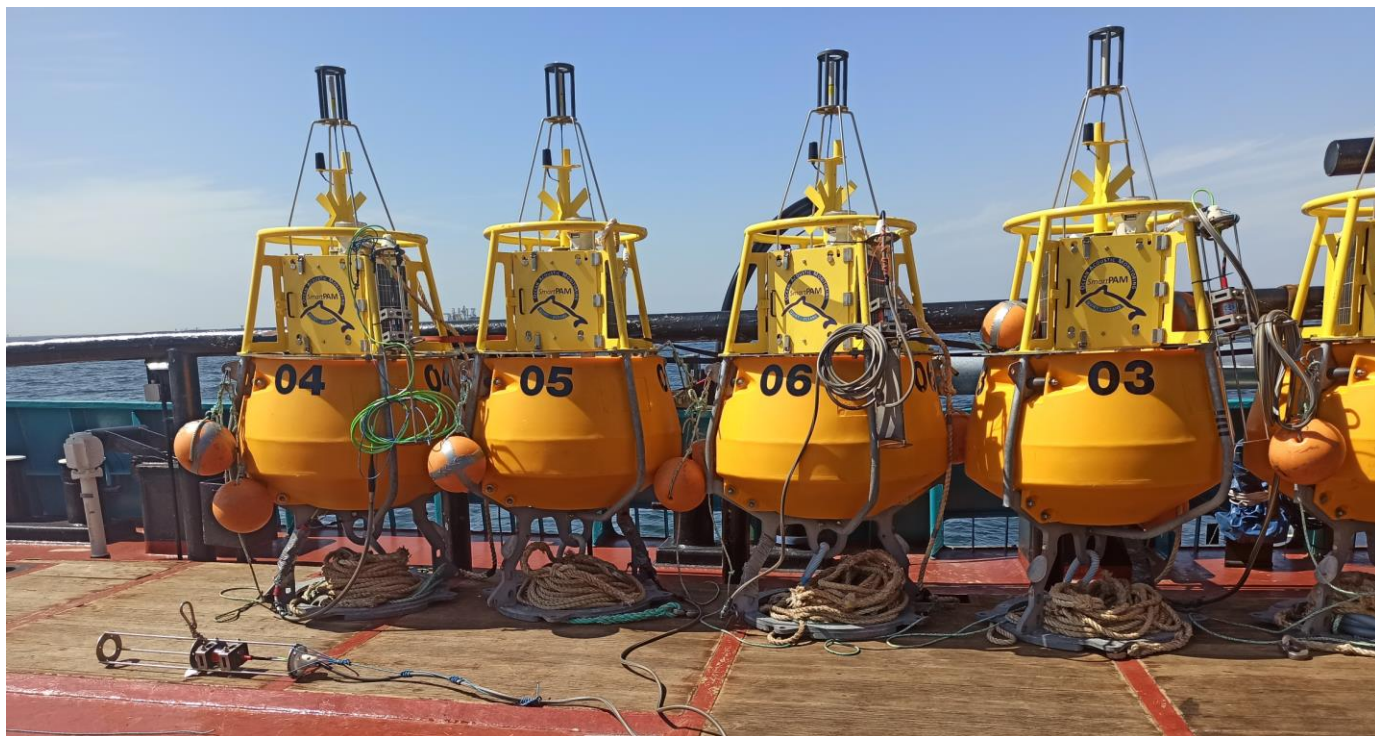
Figure 7 : Bouées Smart-PAM sur pont du navire Alma Kappa (source Quiet-Oceans)
