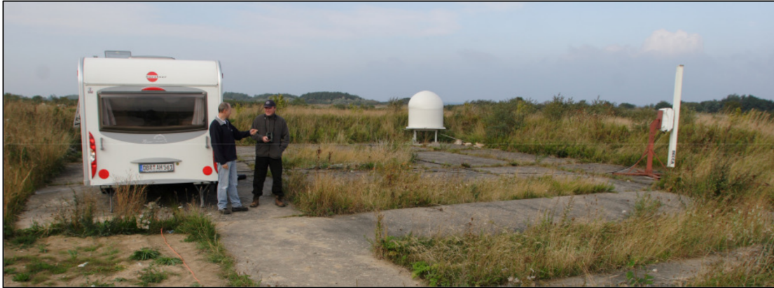
Abb. 5: Anordnung der Radargeräte bei der Parallelmessung auf Rügen im Herbst 2008 (Mitte: Bird Scan unter Radom; Rechts: Bridgemaster 25 kW Vertikalradar).
