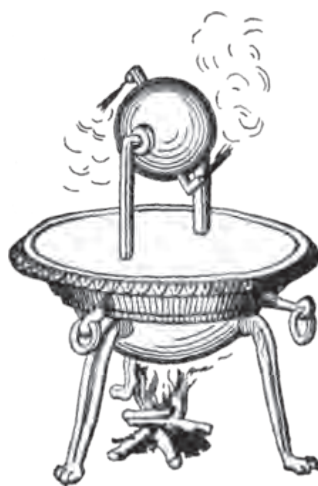
Figura 1. Eolípila, primera máquina a vapor. Fuente: [2]
