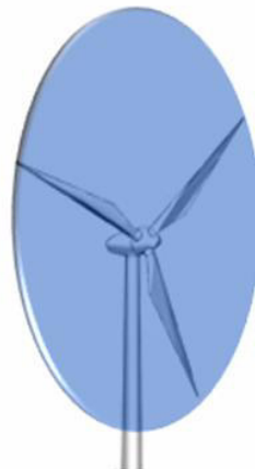
Rotorscheibe (mit Radius der Rotorblattlänge, Tiefe=0)
