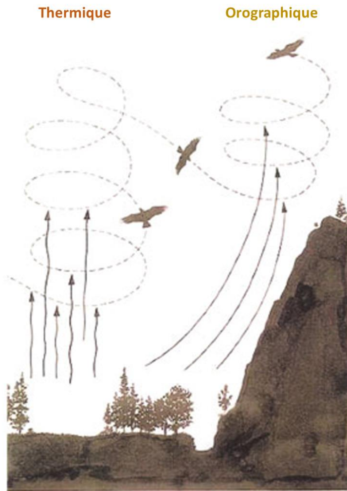
Figure 1.6 : Formation des courants de types thermique et orographique. Source : www.nps.gov
