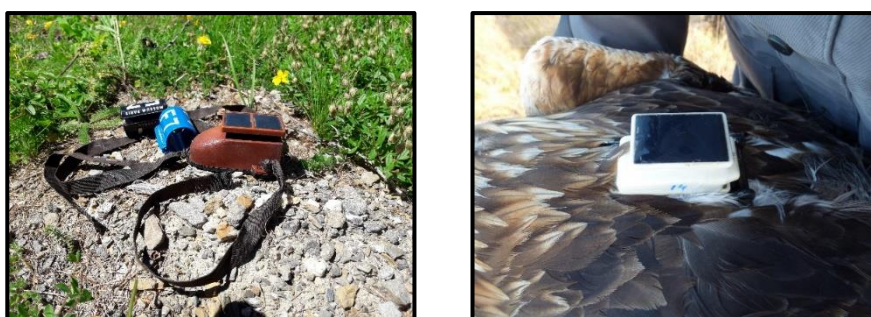
Figure 2.12 : Exemples de bagues et de balises GPS (Ornitela - OT50 à gauche, Ecotone - Skua à droite) utilisées pour équiper les aigles royaux. Crédits : Arzhela Hemery - CNRS (à gauche) et Christian Itty - BECOT (à droite).
