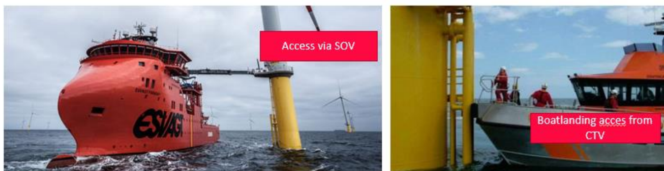
Figur 2-5 Adkomst til vindturbinene via SOV (venstre) og CTV (høyre).
