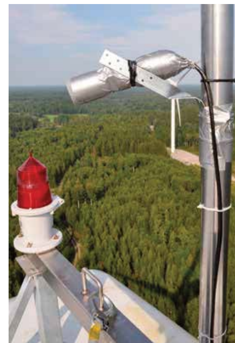
Microphone installé au-dessus de la nacelle pour une étude avec détecteur automatique d'ultrasons. © J. Rydell
