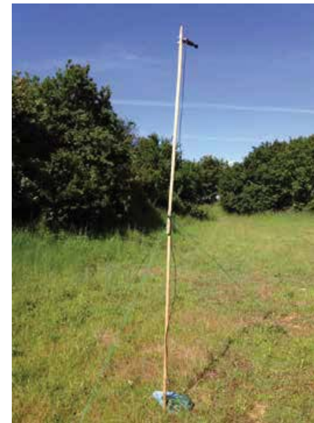
Automatischer Fledermaus-Detektor auf Bodenniveau an einem geplanten Standort von Windkraftanlagen. © J. Sudraut
