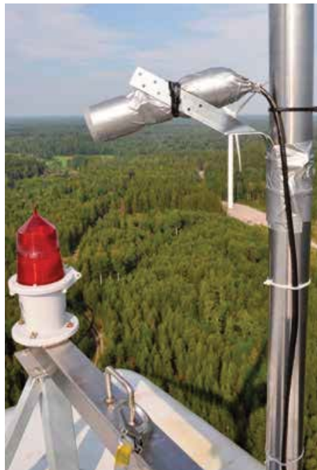
Mikrofon über der Gondel, installiert für eine automatische Fledermausdetektor-Untersuchung. © J. Rydell
