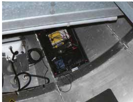
Fern-Mikrofon am Boden der Gondel (oben), verbunden mit automatischem Fledermaus-Detektor in der Gondel (unten) © L. Bach
