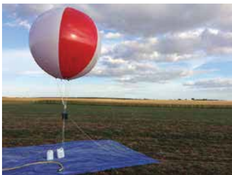
Automatischer Fledermaus-Detektor, an einen Ballon befestigt, zur Fledermaus-Aktivitätsüberwachung während einer Umweltverträglichkeitsprüfung. © J. Sudraud
