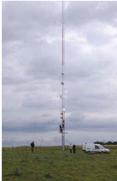
Wettermast mit Fledermaus-Detektoren für die Aufzeichnung der Fledermausaktivität auf der Höhe der Kollisionsrisikozone, Frankreich. © J. Sudraud
