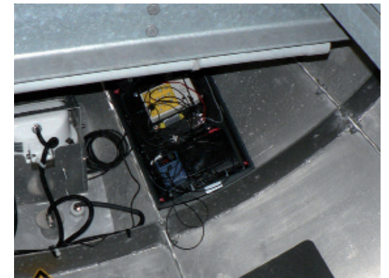
Απομακρυσμένο μικρόφωνο εγκατεστημένο στο κάτω μέρος της ατράκτου (πάνω φωτογραφία) και συνδεδεμένο με αυτοματοποιημένο δέκτη υπερήχων χειροπτέρων μέσα στη άτράκτο (κάτω φωτογραφία). © L. Bach
