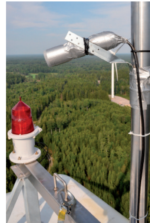
Μικρόφωνο εγκατεστημένο πάνω από την άτρακτο για μελέτη με αυτοματοποιημένους δέκτες υπερήχων. © J. Rydell
