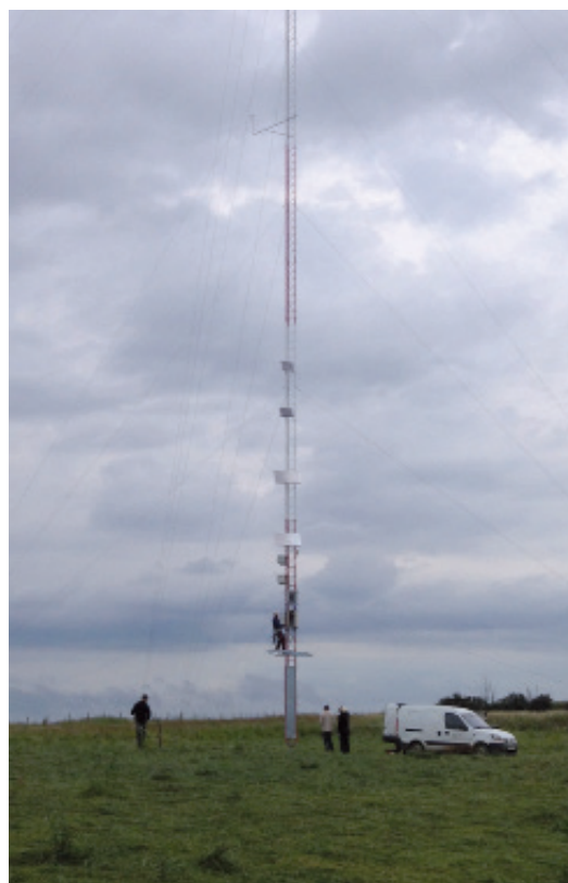
Μετεωρολογικός ιστός με τοποθετημένους δέκτες υπερήχων για την καταγραφή της δραστηριότητας των χειροπτέρων στο ύψος της περιοχής κινδύνου πρόσκρουσης, Γαλλία. © J. Sudraud
