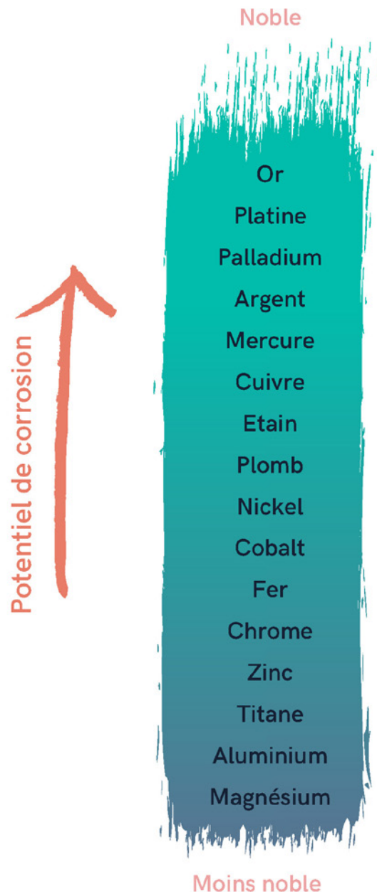
Fig. 1 Schéma du classement de différents métaux selon leur potentiel de corrosion dans un milieu de type « eau de mer ». D'après la définition de la corrosion de l'AFICPAR 3 .
