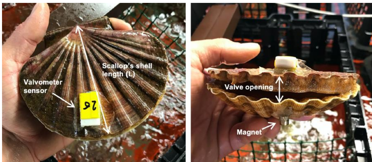
Figure 22 : Coquille Saint Jacques équipé d'un valvomètre (source : Retailleau et al., 2023)
