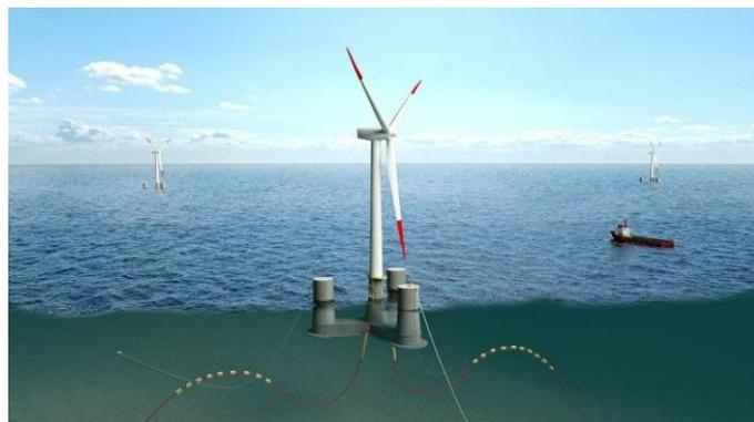
*Figura 10: Representación en 3D de aerogenerador offshore del tipo semisumergible-Fuente: Viladerosos.cat*
