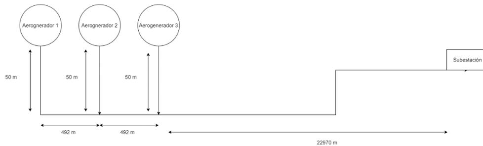
Figura 74: Disposición de cableado- Fuente: Elaboración propia
