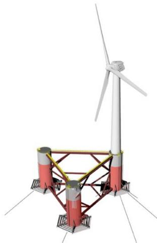
*Figura 59: Representación en 3D plataforma Windfloat-Fuente: PrinciplePower*
