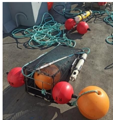
Figure 6 : Enregistreur acoustique autonome (à gauche) et ligne instrumentée avec son panier (à droite).
