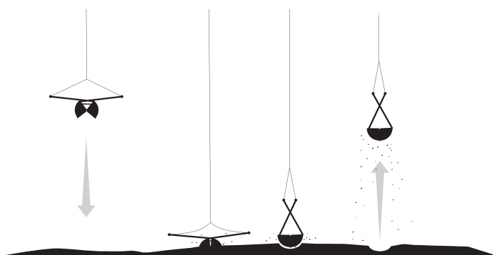
Figura 2. Método de recolha de sedimento para a análise de infauna, utilizando a Dragagem Van Veen.
