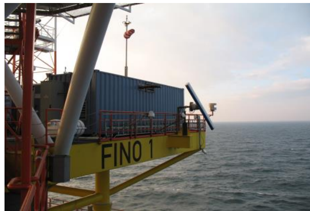
Abbildung 6: Position des vertikal rotierenden Radargerätes auf FINO 1. Die Rotationsebene ist in Richtung WSW ausgerichtet.
