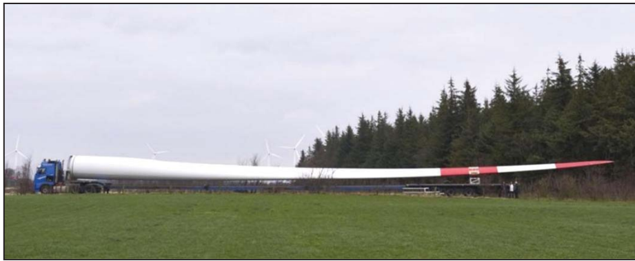
Figura 5-8: Transporte de cargas especiales (pala de rotor)
