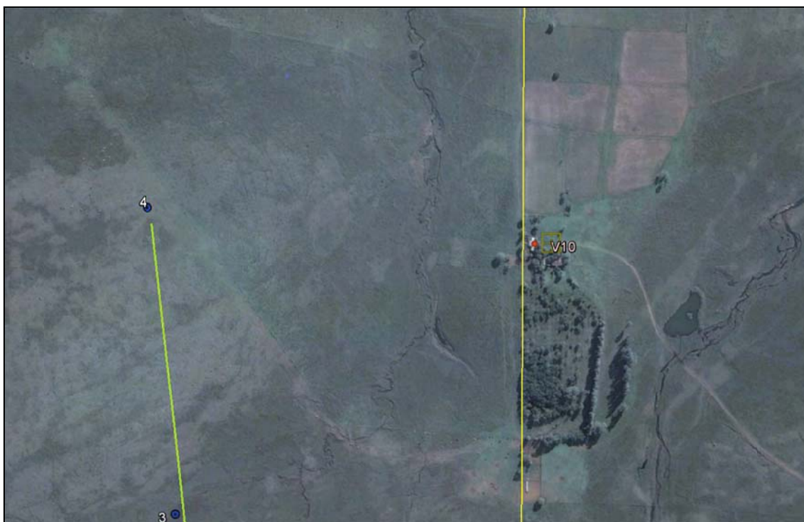
Figura 5-4: Afectación de vivienda por aerogenerador. Distancia V10 – Aero 4 = 497 m.
