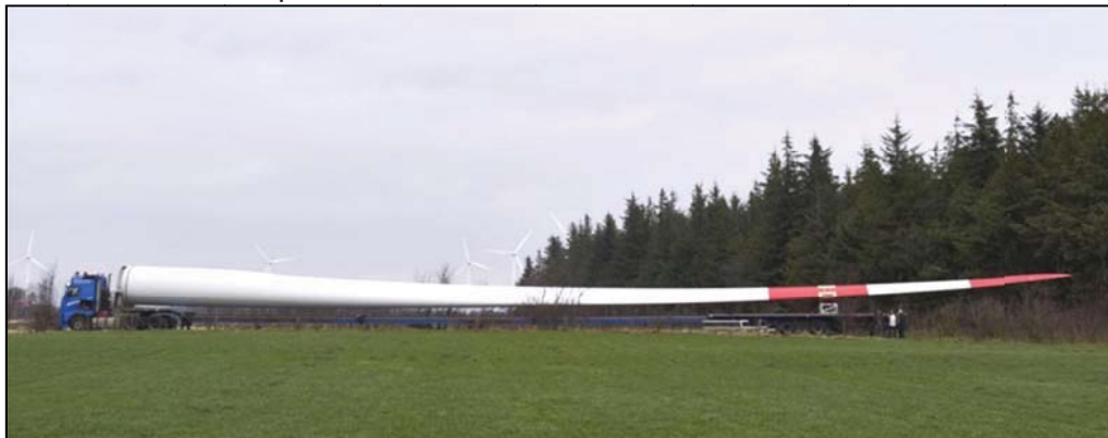
Figura 3-9: Transporte de cargas especiales (pala de rotor)
