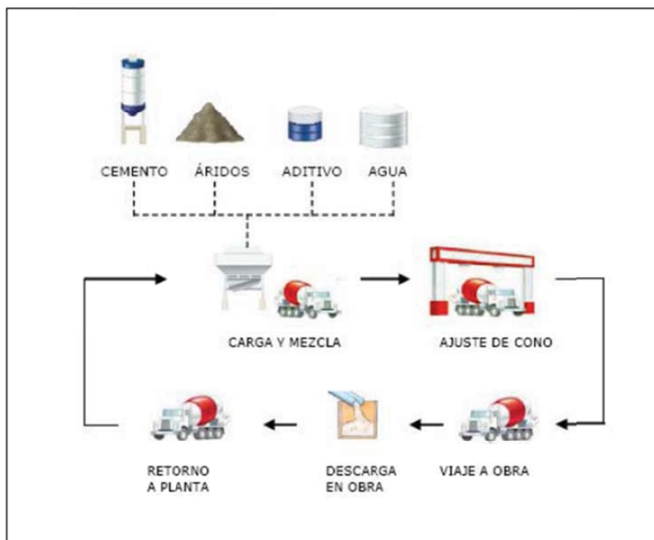
Figura 3-7: Flujo simplificado del proceso de fabricación del hormigón
