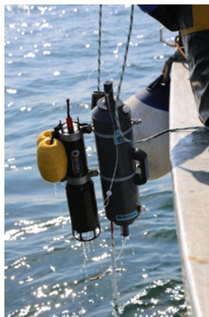
Bouteille Niskin et sonde Wimo utilisés pour le suivi de la qualité de l'eau dans le cadre des campagnes halieutiques MSU3-5-6 menées par Sinay
